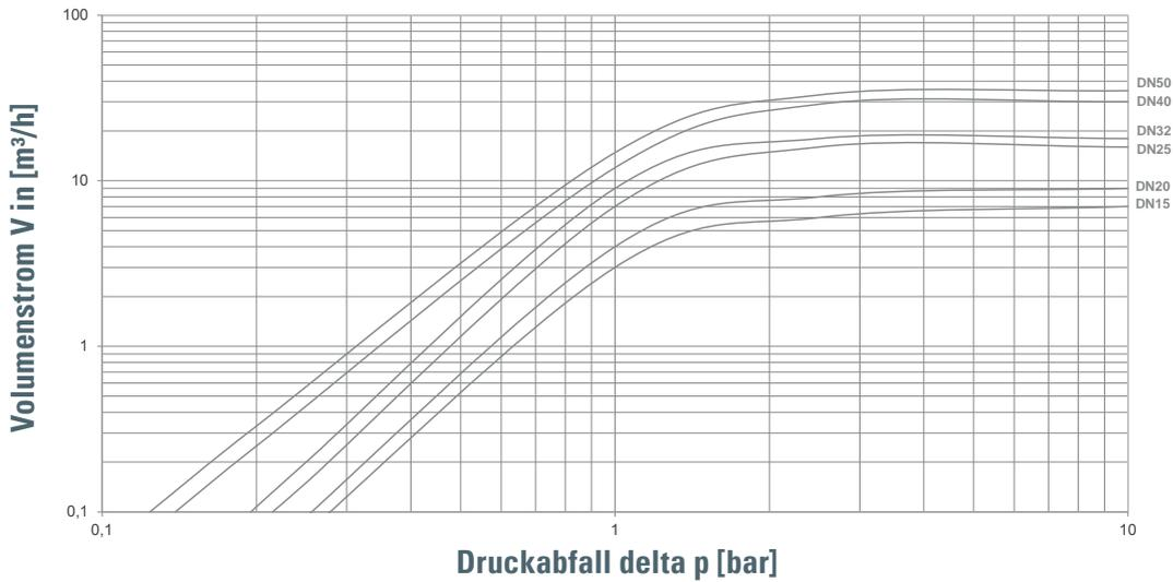
Auslegung über Durchflussgeschwindigkeit
